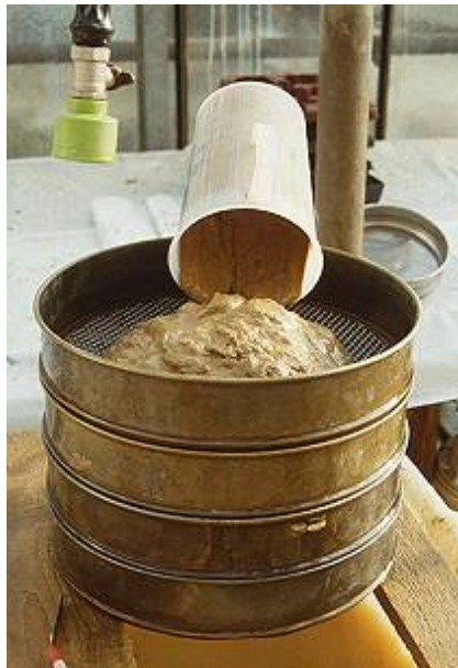
Turmsieb zum Schlämmen der Bodenproben mit 4, 2, 1 und 0,5 mm Sieben.
